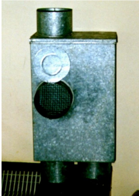
Foto N° 1: Dispositivo regulador domiciliario para bajada de techos
